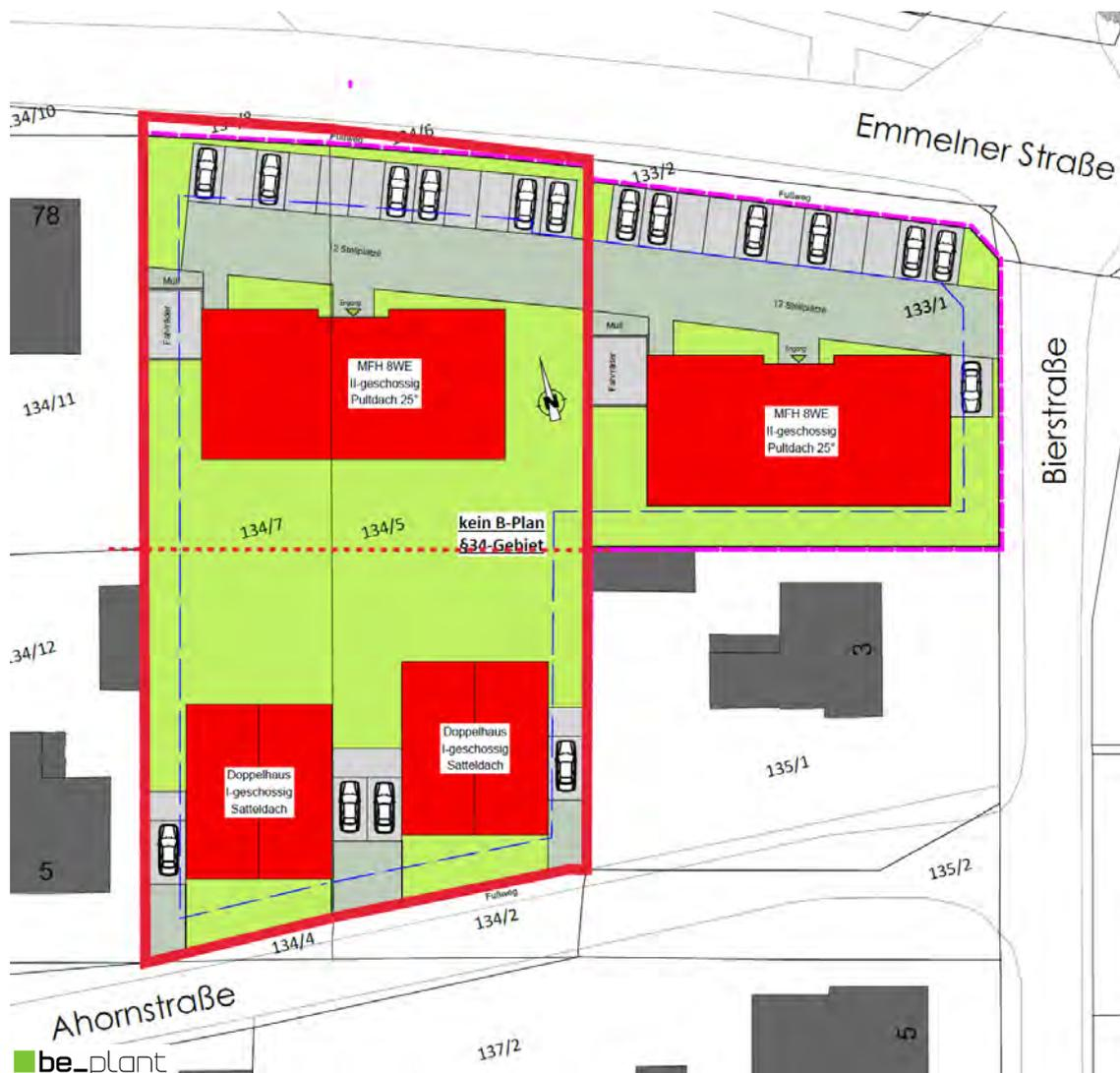
Durch die **Süd-Nord-Ausrichtung** des **Baugrundstücks** könnte der **Baukörper** im **Nördlichen Bereich** zur **Verbesserung der Energieeffizienz (Fotovoltaik)** mit einem **versetzten Pultdach** ausgestattet werden. Ein **vergleichbares Baukonzept** mit **positivem Bauvorbescheid** für das nordöstlich angrenzende Flurstück 133/1 liegt vor (Ecke Emmelner Straße / Bierstraße).
